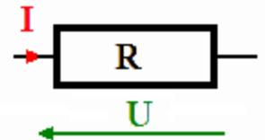
$$U = R.I \Rightarrow \begin{cases} U : \text{tension en volts (V)} \\ R : \text{Résistance en ohms } (\Omega) \\ I : \text{intensité du courant en ampères (A)} \end{cases}$$
